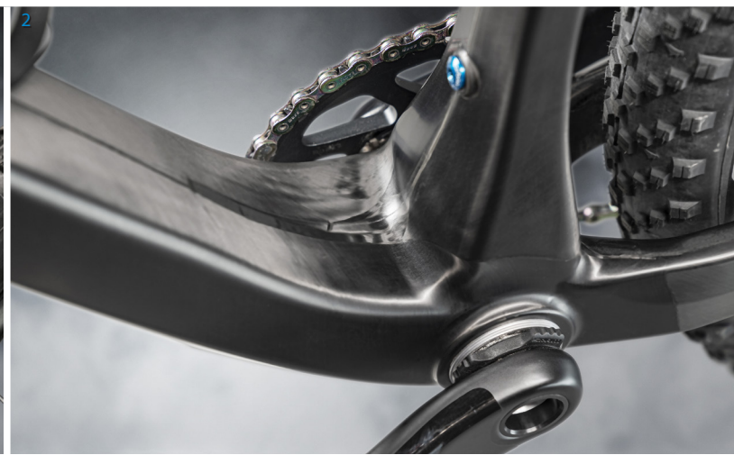
1 | Der Knick in der Sitzstrebe verleiht dem asketischen R1 nicht nur ein unverwechselbares Erscheinungsbild. Durch kontrollierten Flex des Rahmens an dieser Stelle gibt sich das Hardtail überraschend komfortabel. 2 | Einzigartige Optik: Der Carbon-Rahmen ist aufwendig nachgeschliffen und anschließend mit Klarlack überzogen. Die blauen Dekore sind geklebt und lassen sich in Wunschfarbe individualisieren.
