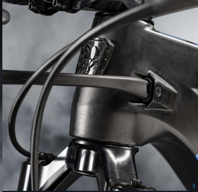
3 | Das Stoll-Logo ziert das Steuerrohr. Für ein klapperfreies, cleanes Cockpit verlaufen die Züge per Kabelkanal und geschraubter Führung zum Rahmen.
