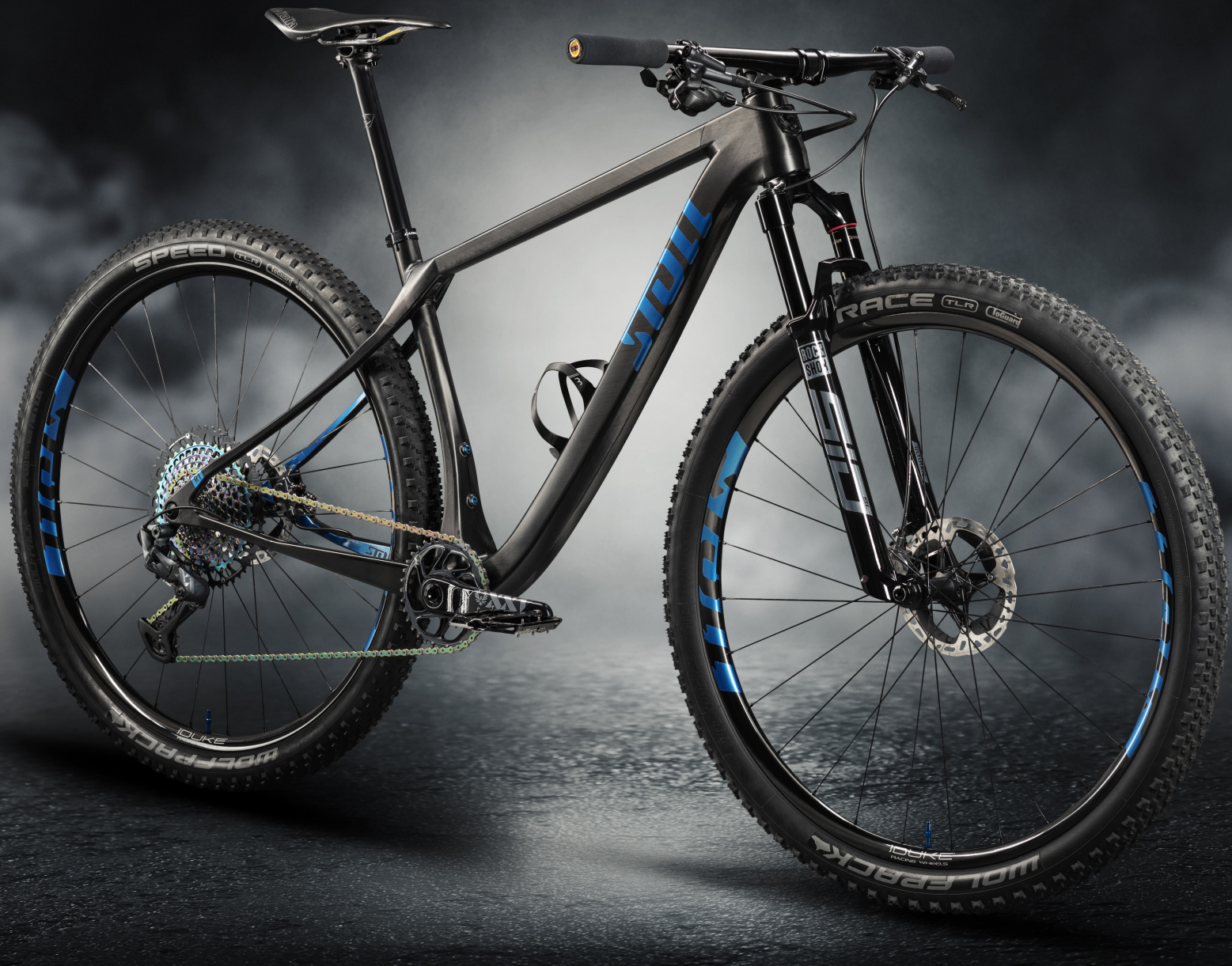
1 | Der Knick in der Sitzstrebe verleiht dem asketischen R1 nicht nur ein unverwechselbares Erscheinungsbild. Durch kontrollierten Flex des Rahmens an dieser Stelle gibt sich das Hardtail überraschend komfortabel. 2 | Einzigartige Optik: Der Carbon-Rahmen ist aufwendig nachgeschliffen und anschließend mit Klarlack überzogen. Die blauen Dekore sind geklebt und lassen sich in Wunschfarbe individualisieren.
